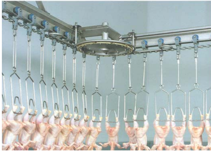
Figuur 1: Leidwiel als onderdeel van de transporthangbaan
